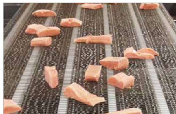
Banda de malla de alambre utilizada para transportar salmón.
